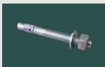
Bodenanker für Palettenregal-Rahmen + zur Bodenbefestigung + 12 mm Ø, 115 mm lang + zulässig für Betongüte C 20/25 + verzinkt oder Edelstahl
